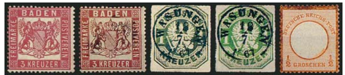
Bleisulfidschäden der Kategorie I (Beispiele, Pos. 1 und 4 Originalfarben)
